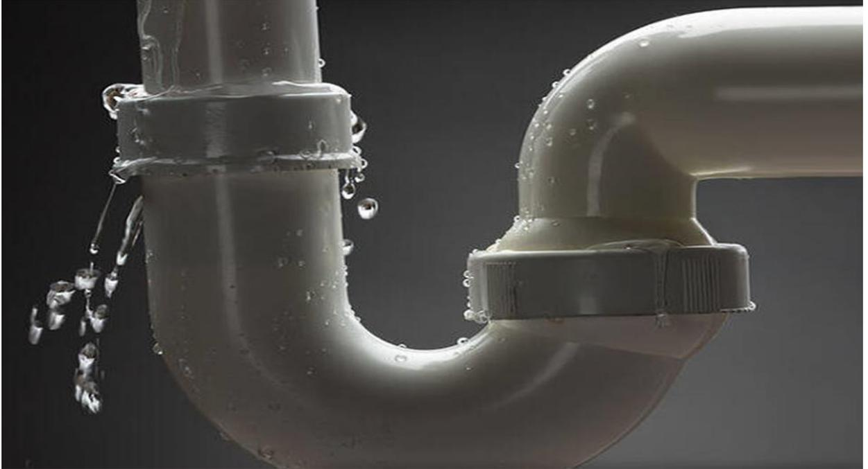
PVC 배관 연결 Bonding 부분에 Chemical로 인한 PVC 본드가 녹으면서 연결 부위에 Leak 발생.
